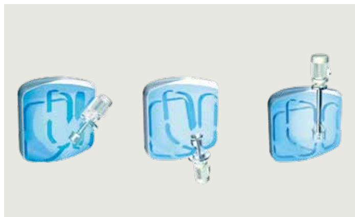
图2 这些混合器可以安装在容器壁、底部或容器盖上
