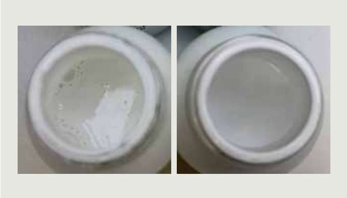
图5 泡沫形成（丙烯酸分散体3）。左侧图像，空白样（评级5 = 严重起泡）；右侧图像，添加0.5%（质量分数）Star2145（评级1 = 无泡沫）
