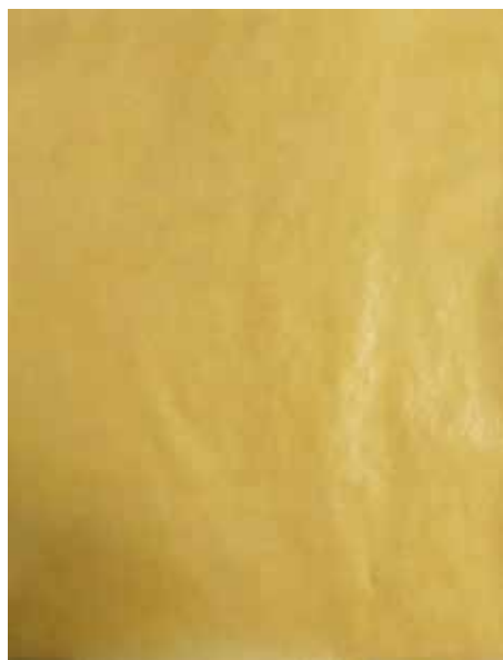
图3 80 g/m 2 的牛皮纸，涂有“Esacote BIO BC 100”，5 g/m 2
